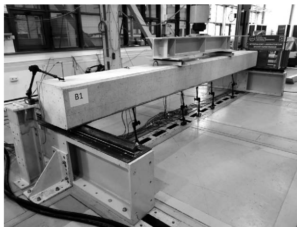
Rys. 3. Widok belki referencyjnej na stanowisku badawczym. Fot. B. Piątek
