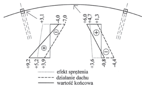
Rys. 6. Wykresy naprężeń normalnych w analizowanych przekrojach sprężonego wieńca obwodowego, MPa
