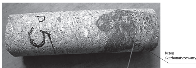
Rys. 10. Widok odwiertu rdzeniowego z zaznaczonym betonem skarbonatyzowanym ocenianym za pomocą rainbow test [7]
